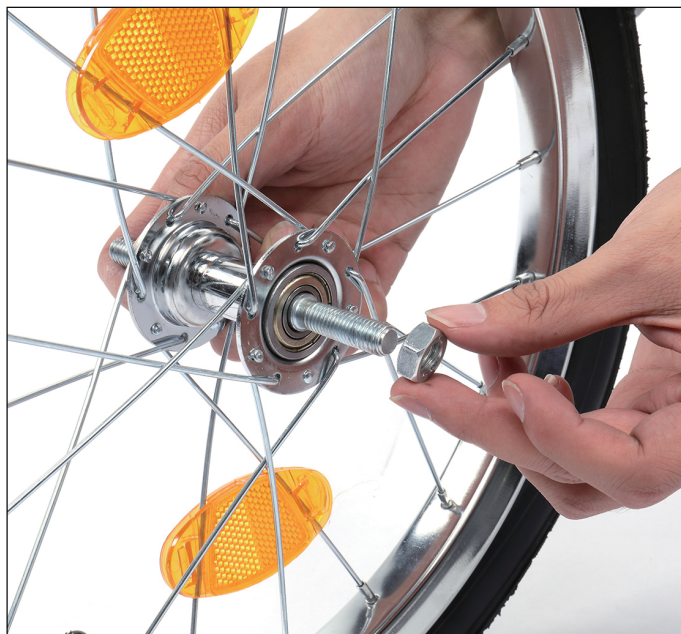
4-Vissez l'axe à l'aide des écrous ( 2 de chaque côté).
