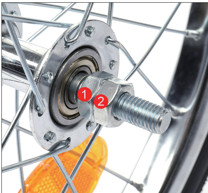
3-Insérez l'axe dans la roue.
