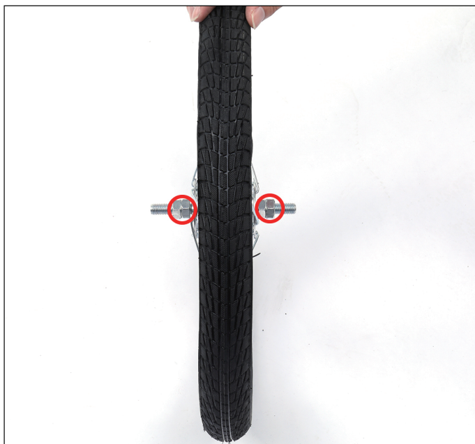
4-Vissez l'axe à l'aide des écrous ( 2 de chaque côté).
